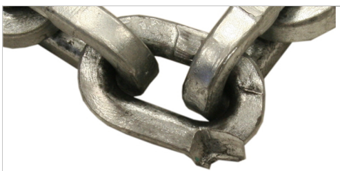
Ketjun lenkki on vaurioitunut mekaanisesti.
