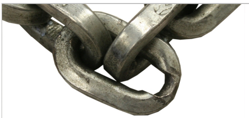
Ketjun lenkki on voimakkaasti kulunut.
